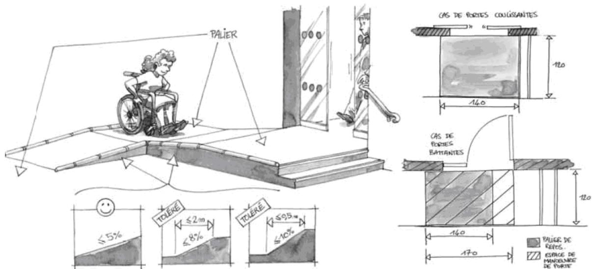
Lorsque la pente est supérieure ou égale à 4% : un palier de repos  $\geq 1,40m$  de long tous les 10m.
